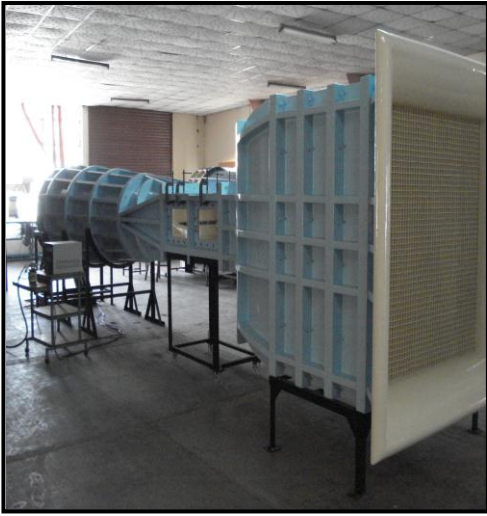
IIT, KARGAPUR. TEST SECTION: 0.45X0.45X1 mts, 30 m/sec
